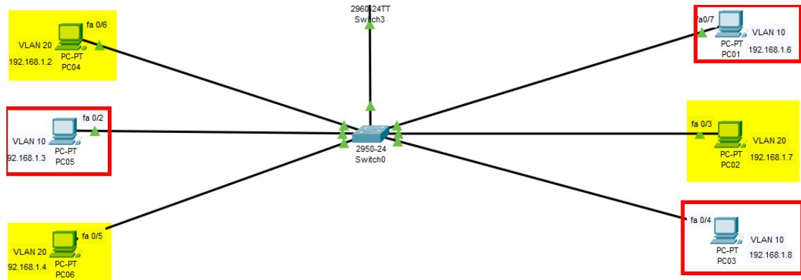
Exemple de ping de PC05 vers PC01 (même réseau et même vlan)
